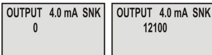
Nach dem Tastendruck UP oder DOWN wird automatisch die Kalibrierkonstante 0 eingelesen. Um diese ändern zu können, muss zuerst mit den Tasten UP oder DOWN die Zahl 11 eingestellt werden. Die ganze Kalibrierkonstante kann dann direkt mit der Tastatur eingegeben werden. Damit wird der Ausgangsstrom von 4 mA definiert und kann noch mit UP oder DOWN fein justiert werden. Die Taste **Enter** schliesst die Kalibration ab. Das Display informiert mit *EEPROM*.
