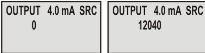
Nach dem Tastendruck UP oder DOWN wird automatisch die Kalibrierkonstante 0 eingelesen. Um diese ändern zu können, muss zuerst mit den Tasten UP oder DOWN die Zahl 11 eingestellt werden. Die ganze Kalibrierkonstante kann dann direkt mit der Tastatur eingegeben werden. Damit wird der Ausgangsstrom von 4 mA definiert und kann noch mit UP oder DOWN fein justiert werden. Die Taste **Enter** schliesst die Kalibration ab. Das Display bestätigt mit *EEPROM*.
