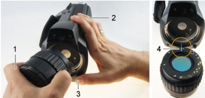
1. Objektiv mit der linken Hand festhalten (1), mit der rechten Hand die Kamera festhalten (2) und die **[Objektivriegelung]** drücken (3).
