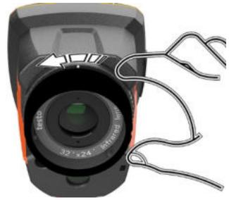
2 Objektiv bis zum Anschlag gegen den Uhrzeigersinn drehen.
