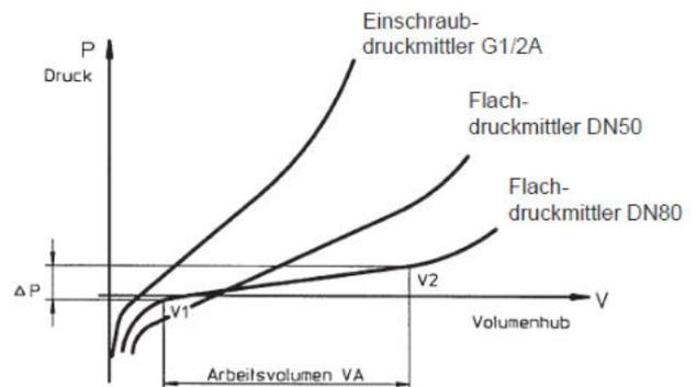
Unsere Druckmittler-Systeme werden grundsätzlich nach berechnetem Füllvolumen gefüllt. Die heutige Technologie ermöglicht uns genaues Dosieren der Systemfüllungen.
