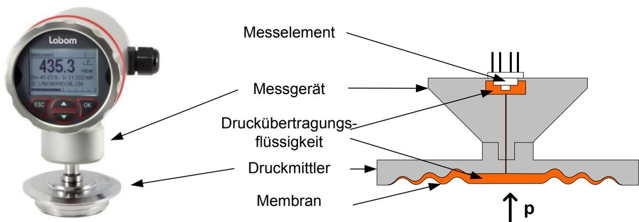
Die Nullpunktstabilität eines Druckmessgerätes mit angeschlossenem Druckmittler wird durch die temperaturbedingten Volumenschwankungen der Füllflüssigkeit stark beeinflusst. Diese Volumenschwankungen müssen durch eine Auslenkung der Druckmittlermembran aufgefangen werden. Durch die Steifigkeit der Membran entsteht dabei eine Veränderung
