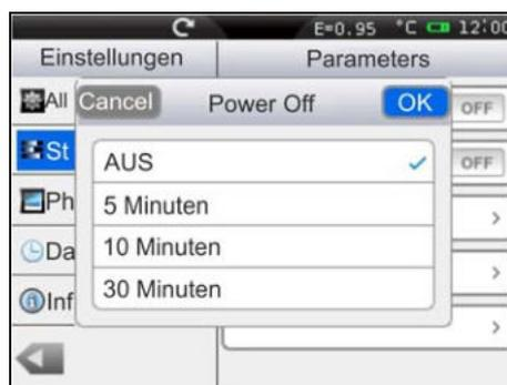
Abb. 16: Einstellung der Zeit der Auto Power Off Funktion des Geräts
