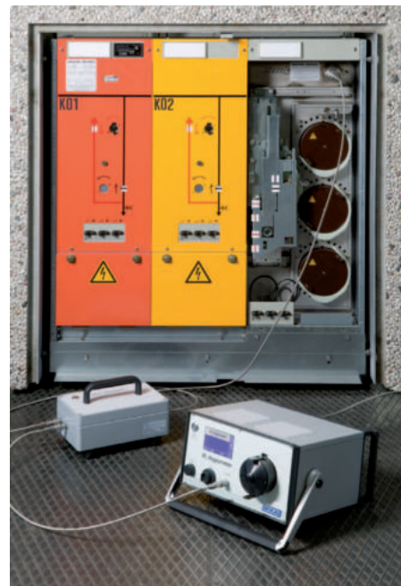
Messaufbau mit Vordruckregleinheit Typ GA05 und Analysegerät GA40
