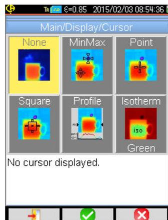
Standardmäßig ist kein Messcursor ausgewählt (Element in Hauptmenü/ Anzeige/Cursor auswählen), und die Kamera erzeugt nur IR-Bilder.
