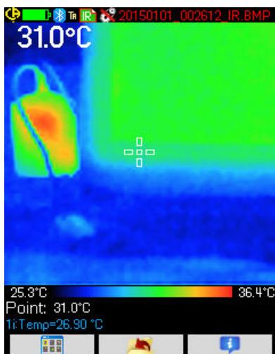
Beim Öffnen eines Bildes werden die Menüs geschlossen und das Bild auf dem Hauptbildschirm angezeigt. Die Statuszeile wechselt (siehe § 1.4.1.1. [Statuszeile](#)), der Dateiname wird in Rot angezeigt.
