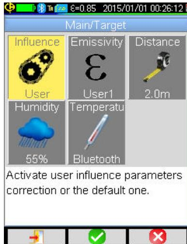
Mit der Benutzer-Einflussparameter-Korrektur lassen sich die verschiedenen Parameter anpassen:
