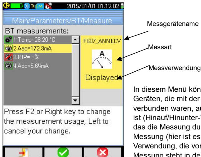
In diesem Menü können Sie alle Messungen von Bluetooth-Geräten, die mit der Kamera bei der letzten Erfassung verbunden waren, auflisten. Wenn eine Messung ausgewählt ist (Hinauf/Hinunter-Tasten), zeigt die rechte Seite das Gerät, das die Messung durchführt, ein Bild zeigt die Art der Messung (hier ist es eine Temperatur) und schließlich die Verwendung, die von dieser Messung gemacht wird (vor der Messung steht in der Liste das entsprechende Symbol).
