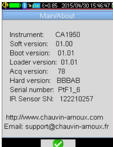
Die aktuelle Firmware-Version der Kamera kann über das Hauptmenü aufgerufen werden (mit **F2**
