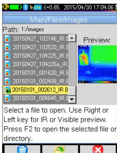
Der Dateimanager listet nur Infrarot-Bilder der Kamera auf, die mit einem Namen wie zum Beispiel jjjjmmmtt\_hhmmssX\_IR.BMP generiert wurden, sowie die Ordner, um ein Verschieben im Navigationsbaum der SD-Karte zu ermöglichen.
