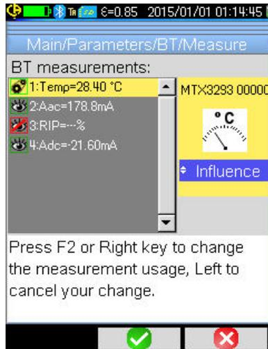
Damit die Messung für die Einflussgröße verwendet werden kann, muss sie als "Einfluss" im Display-Fenster der Bluetooth-Messungen (Hauptmenü / Parameter / Bluetooth / Maßnahmen) zugeordnet werden:
