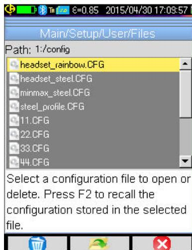
Abrufen einer Setup-Datei: Aus dem Hauptmenü / Konfiguration / Benutzer / Datei über den Dateimanager, der alle im Verzeichnis 1: / config / gefundenen Konfigurationsdateien enthält (Erweiterung .cfg).
