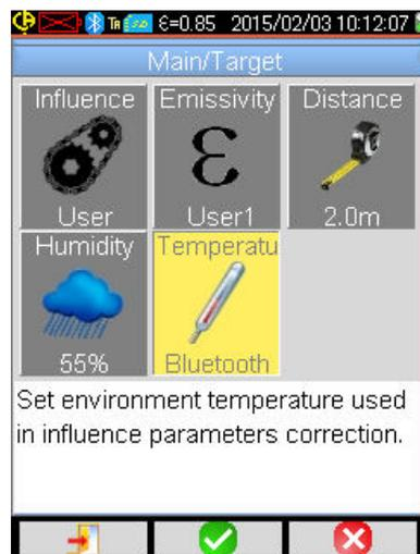
Die Messungen ersetzen die in Hauptmenü/Ziel eingegebenen Benutzerdaten, vorausgesetzt, man hat die Benutzer-Einflussparameter-Korrektur ausgewählt (siehe § 3.2.2. [Benutzer-Einflussparameter-Korrektur verwenden](#)).
