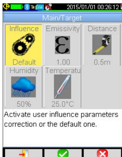
Die Standard-Einflussparameter-Korrektur entspricht der Kamerakalibrierung
