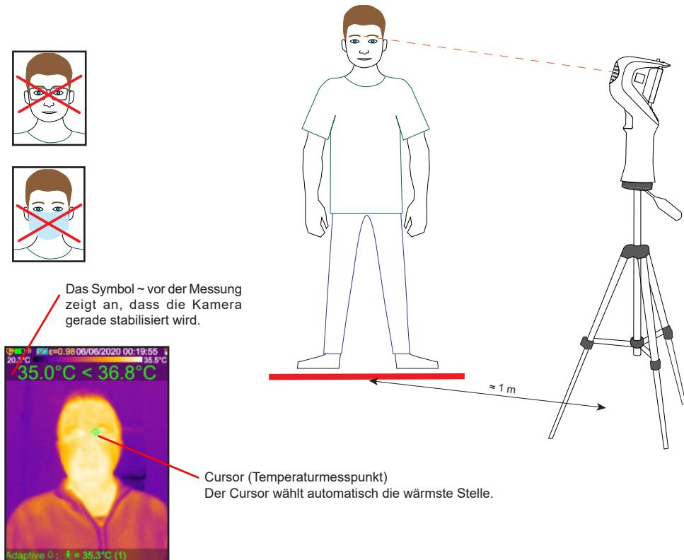
Wenn der Alarm ausgelöst wird, überprüfen Sie zunächst, ob der Cursor im Augenwinkel bzw. an der Stirn der Person misst. Wenn der Cursor am Hals misst, muss die geprüfte Person ihren Hals mit der Hand verdecken.
