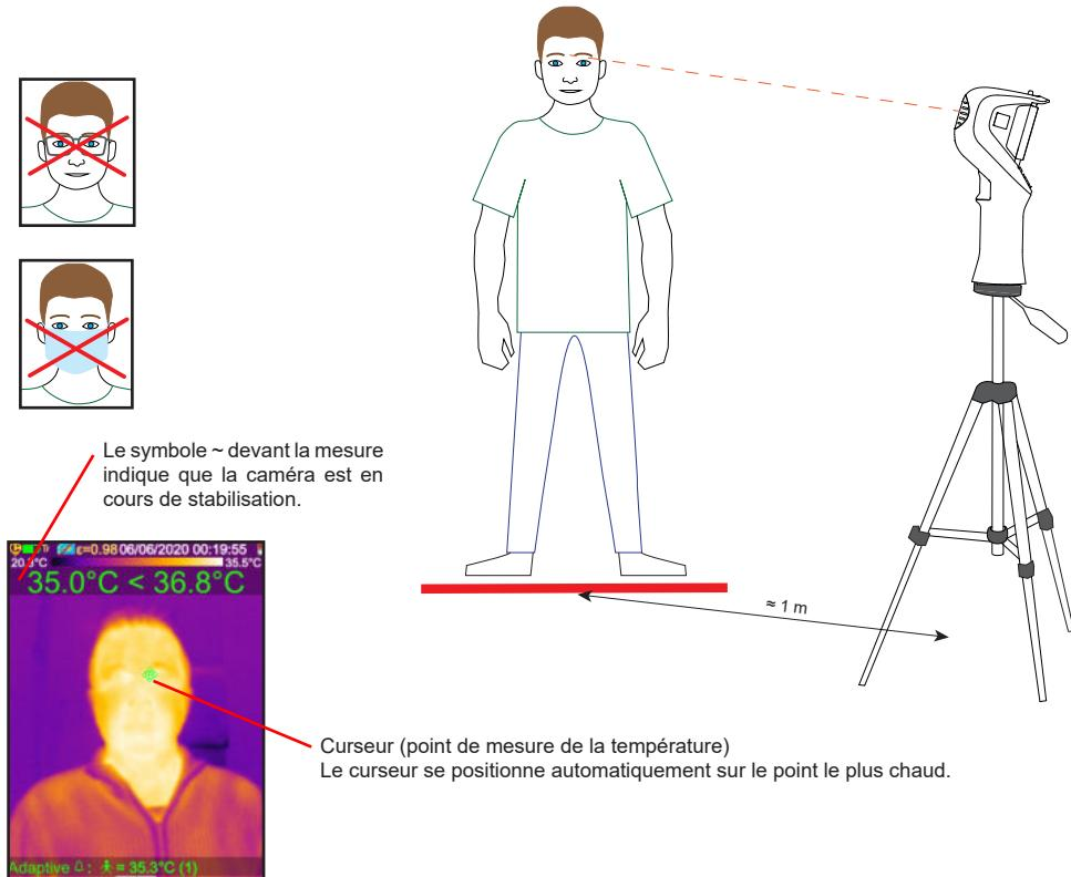
Si l'alarme se déclenche, vérifiez que le curseur est bien positionné au coin de l'œil ou sur le front de la personne. S'il est positionné sur le cou, la personne devra cacher son cou avec sa main.
