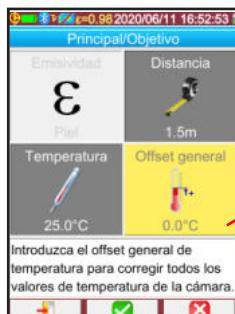
Introduzca el offset general de temperatura para corregir todos los valores de temperatura de la cámara.
