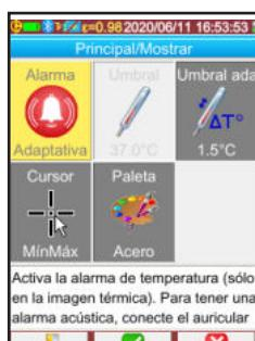
Activa la alarma de temperatura (sólo en la imagen térmica). Para tener una alarma acústica, conecte el auricular
