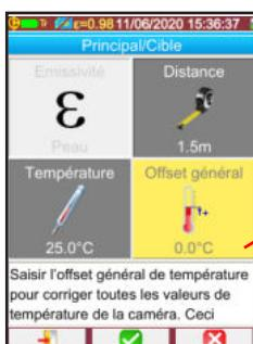
Réglez l'offset général (différence de température entre le front et la température interne) à 2°C.
