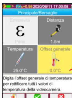
Regolate l'offset generale (differenza di temperatura tra la fronte e la temperatura interna) a  $2^{\circ}\text{C}$ .
