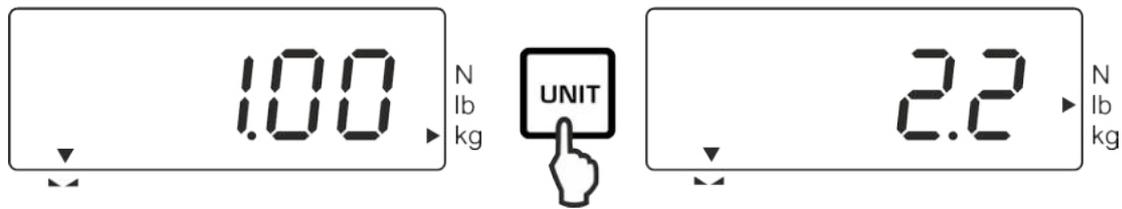
Mit jedem Druck der **UNIT**-Taste wird die nächste Wägeeinheit angezeigt **kg**→ **lb**→**N**. Der Indikator ► zeigt die aktive Einheit an.
