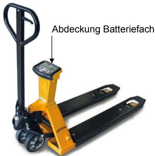
Zum Batteriewechsel die Abdeckung des Batteriefachs auf Rückseite des Anzeigergerätes abschrauben und entfernen. Verbrauchte Batterien gegen neue (4 x 1,5V AA Batterien) austauschen (auf richtige Polung achten) und Batteriedeckel wieder einsetzen.
