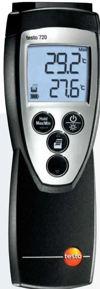
Das testo 720 ist ein robustes Temperatur-Messgerät für präzise Luft-, Oberflächen- und Tauchmessungen im Messbereich von -100 bis +800 °C. Es können sowohl Pt100- als auch NTC-Fühler an das Einkanal-Messgerät angeschlossen werden.
