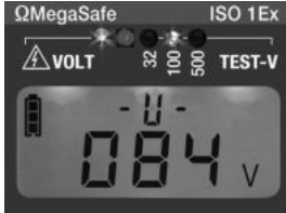
Anzeige der Ladespannung bei angeschlossenen externen Kapazitäten
