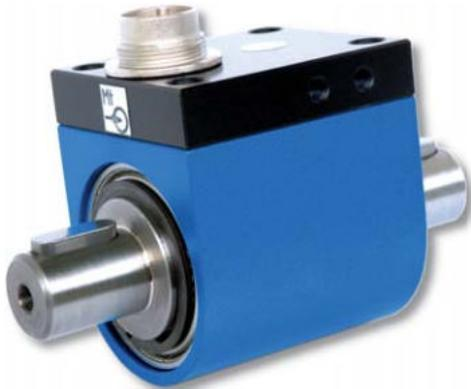
Hochgenauer Drehmomentsensor, beidseitig mit einer zylindrischen Welle mit Passfeder ausgestattet. Er ist mit verschiedenen Messbereichen erhältlich und auf eine Dauerdrehzahl von 1.500 bis 2.000 U/min ausgelegt.
