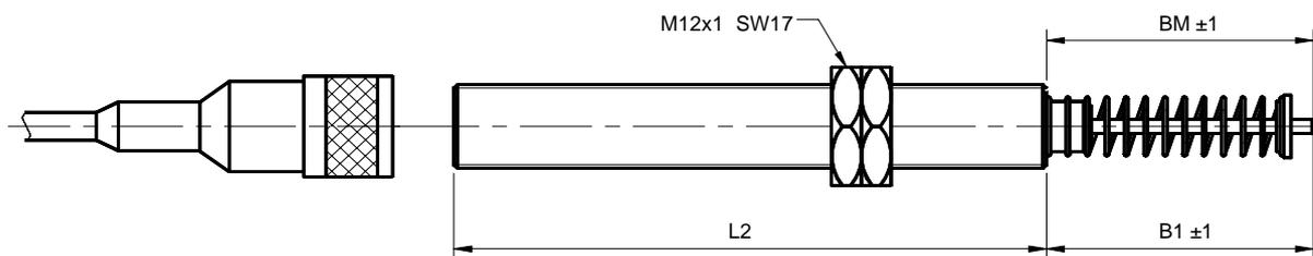
Federkraft in Mittelstellung ~2N
