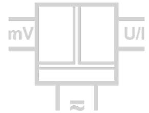
Trennung und Wandlung von bipolaren und unipolaren mV-Spannungen
